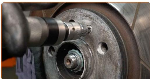
**14** Remova o parafuso de fixação.
