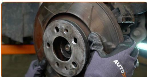
**16** Limpe o suporte da pinça de travão para remover a sujidade e o pó. Use uma escova metálica. Utilize um produto de limpeza para travões.
