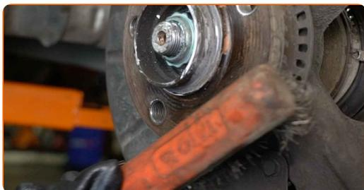
**18** Trate a superfície de contacto. Utilize massa lubrificante de cerâmica.
