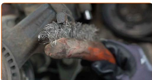
**17** Limpe o cubo de roda. Use uma escova metálica. Utilize um produto de limpeza para travões.
