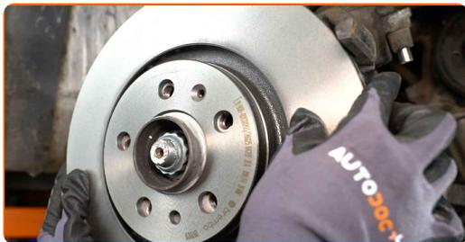
**20** Instale o parafuso de fixação.
