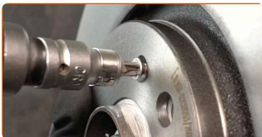
**21** Aperte os fixadores do disco de travão. Use a chave Phillips. Use uma chave de torque. Aperte-o para o torque de 4 Nm.
