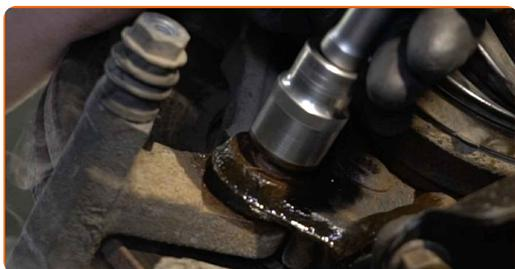
**15** Retire os parafusos de fixação.
