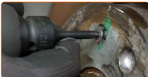
**19** Remova o parafuso de fixação.
