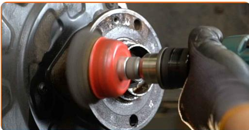
**22** Trate a superfície de contacto. Utilize massa lubrificante de cerâmica.
