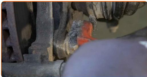
**14** Desaperte os parafusos do suporte da pinça do travão. Use uma chave soquete nº 21. Use uma chave de catraca.
