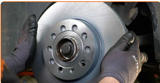
**24** Instale o parafuso de fixação.
