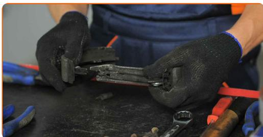
**17** Proceda ainda à desmontagem da mola de retenção superior e do mecanismo de regulação. Use alicates.
