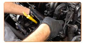
Aperte o fixador do suporte da bomba de ar secundária. Use HEX n.º H6 Use uma chave soquete nº 13. Use uma chave de torque. Aperte-o para o torque de 9 Nm.
