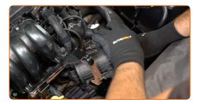
Desaparafuse o fixador do suporte da bomba de ar secundária. Use HEX n.º H6. Use uma chave soquete nº 13. Use uma chave de catraca.
