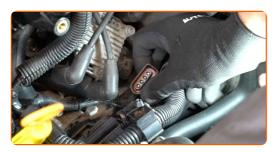
Desconecte os fios da vela de ignição da bobina de ignição.
