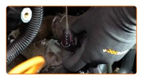
Trate dos fios conectores das velas de ignição. Use spray eletrónico.
