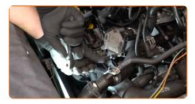
13 Remova a bobina de ignição.
