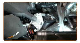
Apertar a fixação da bobina de ignição. Use HEX n.º H5. Use uma chave de torque. Aperte-o para o torque de 7 Nm.
