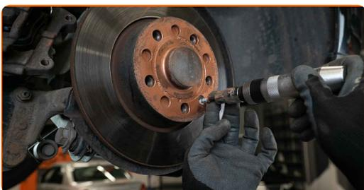
Substituição: discos de travão – VW Caddy III Carrinha (2KB, 2KJ, 2CB, 2CJ).
