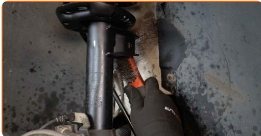
**66** Instale o terminal do estabilizador transversal.
