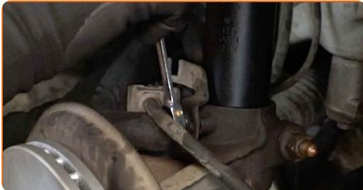
**65** Limpe os assentos de montagem do tirante da barra estabilizadora. Use uma escova metálica. Use spray WD-40.
