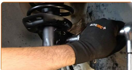
**68** Trate os fixadores do amortecedor. Trate todas as juntas do braço. Trate todas as juntas de conexão do estabilizador. Use massa de cobre.
