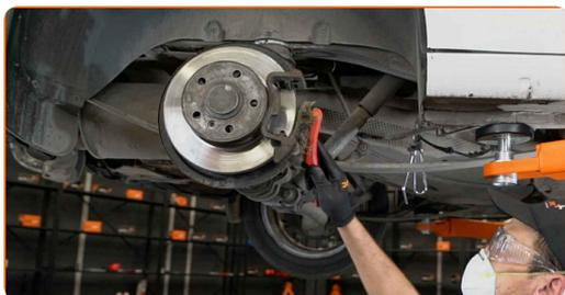
Substituição: pinças de travão – VW Caddy III Van (2KA, 2KH, 2CA, 2CH).
