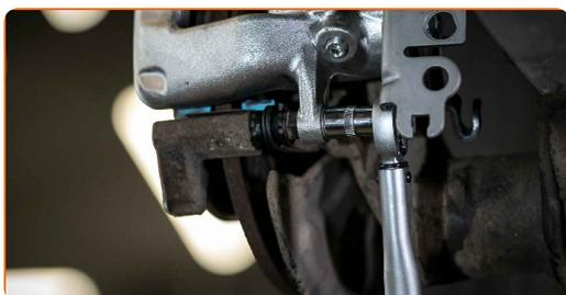
**27** Limpe a sujidade do parafuso da mangueira do travão. Utilize um produto de limpeza para travões.
