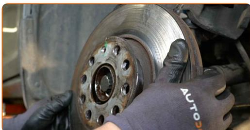
**21** Limpe o cubo. Use uma escova metálica. Use o spray de limpeza universal.
