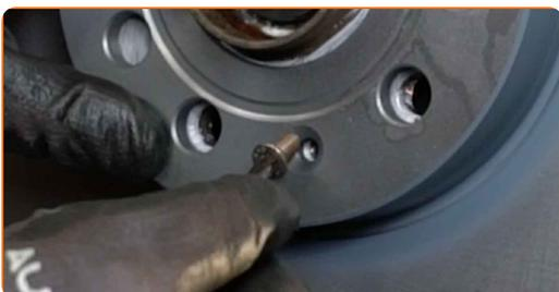
**25** Aperte a fixação do disco de travão. Use Torx T30. Use uma chave de torque. Aperte-o para o torque de 8 Nm.
