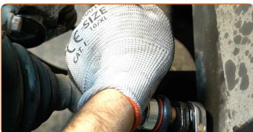
**13** Desaparafuse o fixador que conecta bieleta da barra estabilizadora à barra estabilizadora. Use uma chave combinada nº 18. Use uma chave soquete nº 18. Use uma chave de torque. Aperte-o para o torque de 65 Nm.
