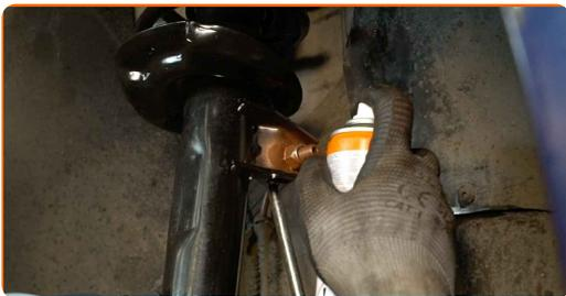
**15** Trate a superfície onde o disco de travão entra em contacto com o aro da roda. Use massa de cobre.
