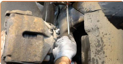
**12** Aperte o fixador que conecta a bieleta da barra estabilizadora à barra estabilizadora. Use uma chave combinada nº 18. Use uma chave soquete nº 18. Use uma chave de torque. Aperte-o para o torque de 65 Nm.
