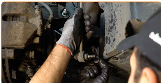
Substituição: tirante da barra estabilizadora – VW Caddy V Van (SBA, SBH).
