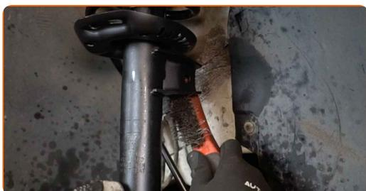
**44** Instale o terminal do estabilizador transversal.
