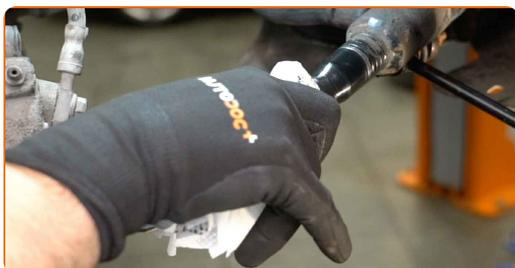
**26** Remova a mola de retenção da junta homocinética. Use uma chave de fenda plana.
