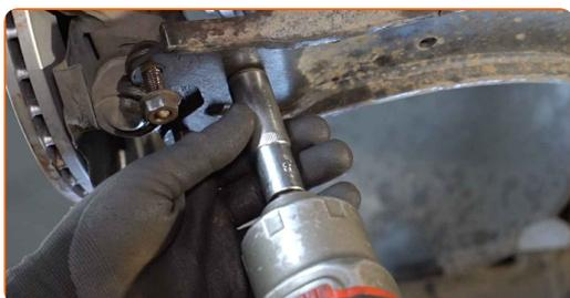
**41** Instale e aperte o parafuso do eixo de transmissão. Use uma chave soquete nº 27. Use uma chave de catraca.
