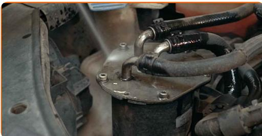
4 Desparafuse os fixadores da capa da carcaça do filtro de combustível. Use Torx T15. Use uma chave de catraca.
