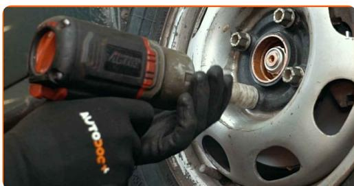
**22** Baixar o carro e trabalhar em ordem transversal, apertar os parafusos das rodas. Use o soquete de impacto para roda #17. Use uma chave de torque. Aperte-o para o torque de 110 Nm.
