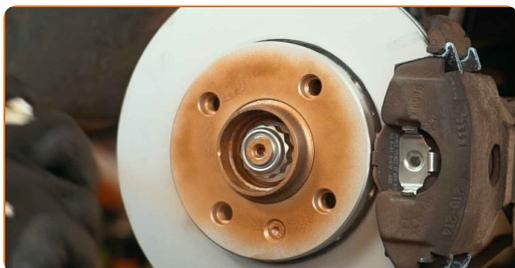
**19** Limpe a superfície do disco de travão. Utilize um produto de limpeza para travões.
