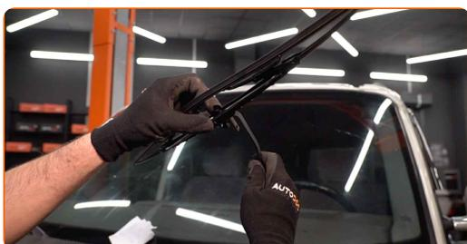
Substituição: escovas do limpa vidros – VW Fox Hatchback (5Z1, 5Z3, 5Z4).
