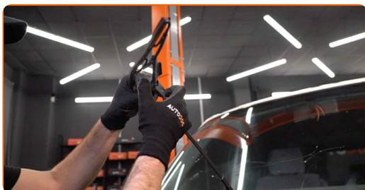
Substituição: escovas do limpador de vidros – VW Fox Hatchback (5Z1, 5Z3, 5Z4).
