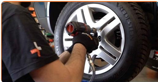
**20** Baixe o carro e trabalhar em ordem transversal, apertar os parafusos das rodas. Use uma chave de torque. Aperte-o para o torque de 120 Nm.
