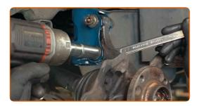
Limpe os assentos de montagem do terminal da direção. Use uma escova metálica. Use spray WD-40.
