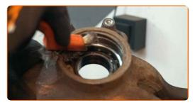
Remova o anel de retenção do mancal do cubo de roda. Utilize o alicate de anilhas.
