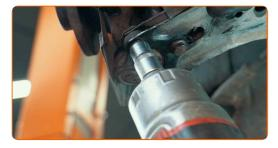
Instale o parafuso de fixação.
