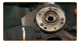
Aparafuse os fixadores da proteção dos discos de travão. Use uma chave soquete nº 8. Use uma chave de torque. Aperte-o para o torque de 5 Nm.
