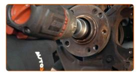
Limpe o cubo. Use uma escova metálica. Use o spray de limpeza universal. Trate a superfície de contacto. Use massa de cobre.
