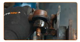
Aparafuse a porca de fixação que liga o terminal de direção à manga do eixo. Use uma chave soquete nº 19. Use uma chave de catraca.
