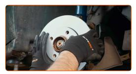
Aperte a fixação do disco de travão. Use Torx T27. Use uma chave de torque. Aperte-o para o torque de 9 Nm.
