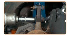
Remova o parafuso de fixação.
