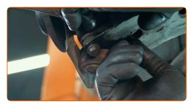
Instale a manga de eixo no eixo da junta homocinética.
