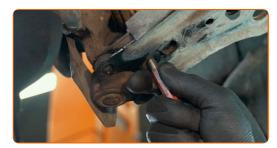
Aparafuse o fixador que liga a junta esférica ao braço de controlo. Use uma chave soquete nº 13. Use uma chave de catraca.
