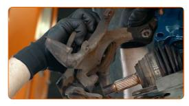
Limpe os fixadores de proteção dos discos de travão. Use uma escova metálica. Use spray WD-40.
