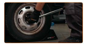
Apertar os parafusos da roda usando um padrão cruzado. Use o soquete de impacto para roda #17. Use uma chave de torque. Aperte-o para o torque de 110 Nm.
