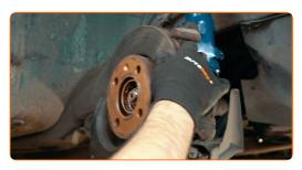
Desaperte o fixador que liga o eixo de transmissão ao cubo de roda. Use uma chave soquete nº 30. Use uma chave de catraca.
