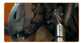
Trate os fixadores da rótula de suspensão. Trate o fixador do eixo CV. Trate a porca de fixação conectada ao terminal de direção à manga de eixo. Trate os fixadores do amortecedor. Use massa de cobre.
