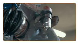
Aperte os fixadores que ligam a junta esférica ao braço de suspensão. Use uma chave soquete nº 13. Use uma chave de torque. Aperte-o para o torque de 20 Nm.+90°
