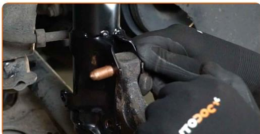
**36** Aparafuse os fixadores que ligam o suporte de suspensão à manga de eixo. Use uma chave combinada nº 18. Use uma chave soquete nº 18. Use uma chave de tarraxa.
