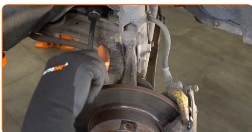
**12** Desaperte o suporte de fixação da mangueira do travão do amortecedor. Use uma chave soquete nº 10. Use uma chave de catraca.
