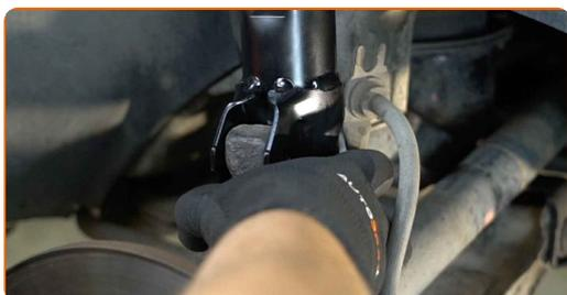
**35** Instale os parafusos de fixação.
