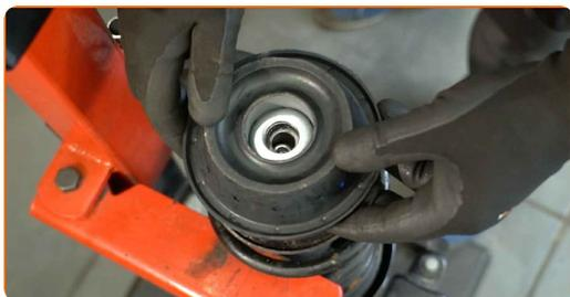
**26** Aperte a porca do suporte do amortecedor da haste do pistão. Use uma chave combinada nº 21. Chave para a porca do amortecedor de 14,5 mm. Use uma chave de torque. Aperte-o para o torque de 60 Nm.
