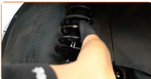
**39** Aparafuse a fixação superior de montagem do suporte do amortecedor. Não o aperte.
