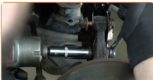
**44** Aperte os fixadores inferiores que conectam a coluna de suspensão à manga de eixo. Use uma chave combinada nº 18. Use uma chave soquete nº 18. Use uma chave de torque. Aperte-o para o torque de 95 Nm.
