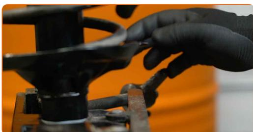
**37** Limpe os assentos de montagem da coluna do amortecedor. Use uma escova metálica. Use spray WD-40.
