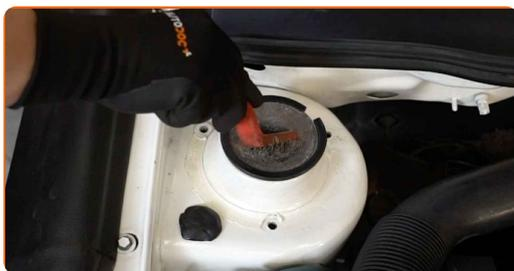
**4** Solte o fixador superior do apoio da coluna de suspensão. Use HEX n.º H6. Use uma chave soquete n.º 21. Use uma chave de catraca.
