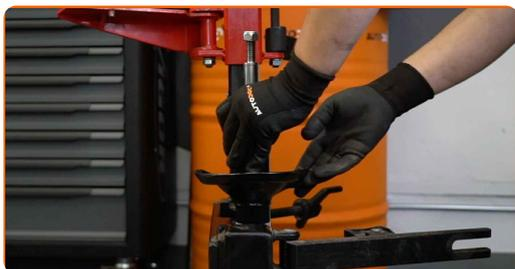
**29** Instale a manga para poeiras e a bomba de bloqueio no novo amortecedor.
