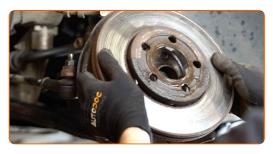
Limpe o cubo. Use uma escova metálica. Trate a superfície de contacto. Use massa de cobre.
