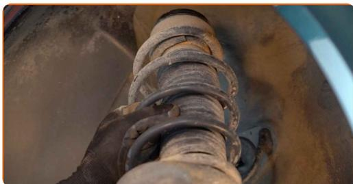
**25** Coloque o suporte do amortecedor sobre a ferramenta de compressão da mola.
