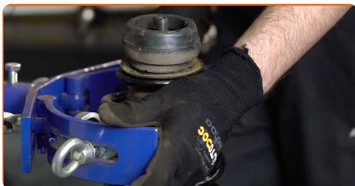
41 Retire a coluna de suspensão montada.
