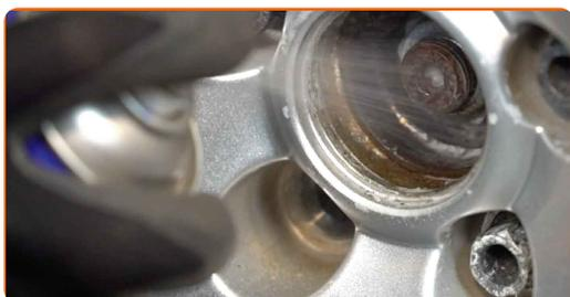
**5** Solte o fixador do eixo de transmissão. Use a chave de caixa de 12 pontos n.º 30. Use uma chave de tarraxa.
