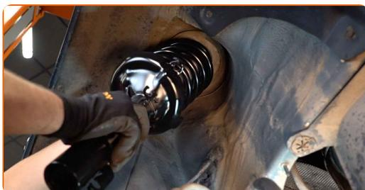
43 Aparafuse a fixação superior de montagem do suporte do amortecedor. Use uma chave soquete nº 13. Não o aperte.
