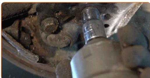
**52** Aperte os fixadores inferiores que conectam a coluna de suspensão à manga de eixo. Use uma chave soquete nº 18. Use uma chave combinada nº 18. Use uma chave de torque. Aperte-o para o torque de 60 Nm.+90°
