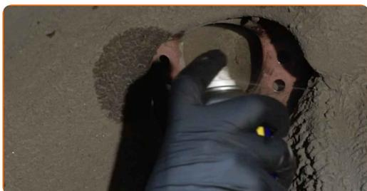
**24** Trate os assentos de montagem do amortecedor. Use massa de cobre.
