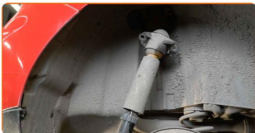
**13** Remova a tampa protetora do suporte do amortecedor.
