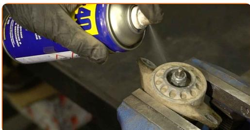
**16** Retire a fixação da haste do pistão do amortecedor. Use uma chave soquete nº 16. Utilize a chave para amortecedor DDNº6. Use uma chave de catraca.
