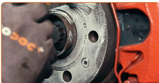
**17** Limpe a superfície do disco de travão. Utilize um produto de limpeza para travões.
