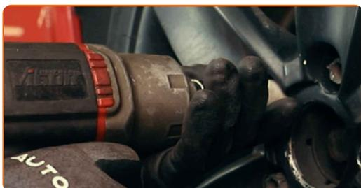
**20** Baixar o carro e trabalhar em ordem transversal, apertar os parafusos das rodas. Use o soquete de impacto para roda #17. Use uma chave de torque. Aperte-o para o torque de 120 Nm.
