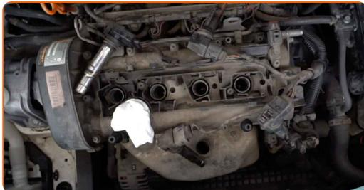
**Substituição: bobina de ignição – VW Golf Plus / Crossgolf (5M1, 521).**
