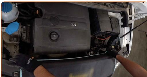
**3** Desconecte a mangueira de ventilação do cárter da tampa do motor.
