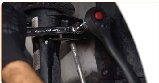
**18** Desaperte o fixador que liga o eixo de transmissão ao cubo de roda. Use uma chave de caixa de 12 pontos #24.
