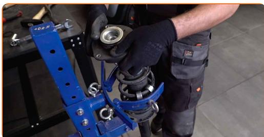
**35** Instale o novo suporte do amortecedor, o fole e o batente no amortecedor.
