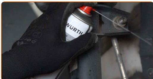
**17** Desaperte a porca e remova a barra estabilizadora do amortecedor. Use uma chave combinada nº 16. Use XZN #6. Use uma chave de catraca.
