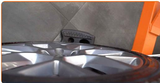
**5** Desaperte os parafusos da roda.
