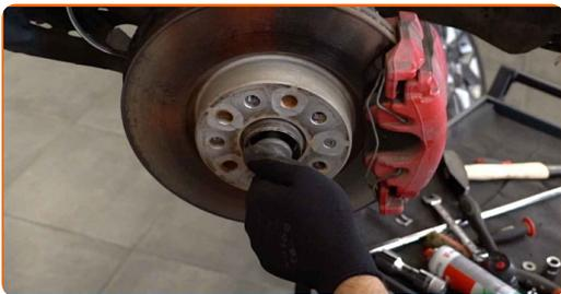
**19** Desaperte o fixador que liga a rótula de suspensão ao braço da suspensão. Use uma chave soquete nº 16. Use uma chave de catraca.
