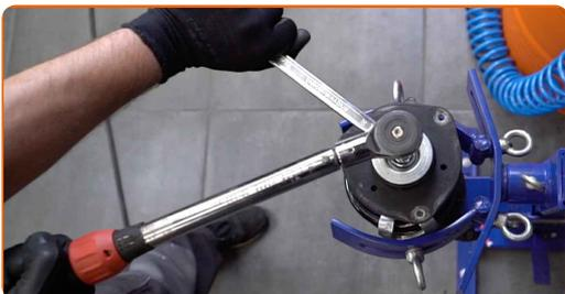
**Substituição: cabeçotes do amortecedores – VW Golf V Variant (1K5).
