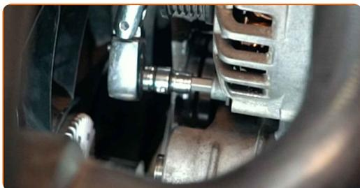
**24** Demontați alternatorul.
