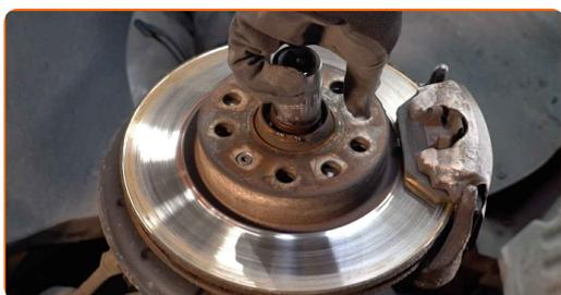
24 Remova o parafuso de fixação.
