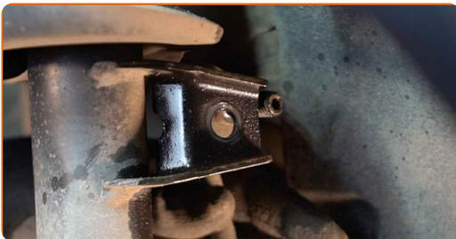
**18** Desaparafuse o elemento de fixação inferior que liga a coluna de suspensão às mangas de eixo. Use uma chave soquete nº 18. Use XZN #12. Use uma chave de catraca. Use uma chave de tarraxa.
