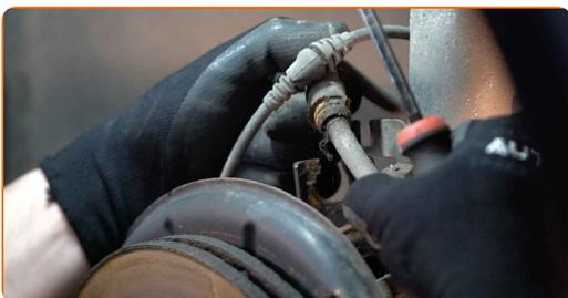
**14** Limpe os elementos de fixação de conexão do estabilizador. Use uma escova metálica. Use spray WD-40.
