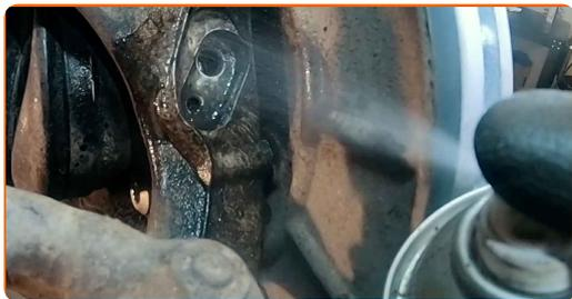
**11** Trate o fixador do sensor de ABS. Use um lubrificante multiusos. Use uma chave de fenda plana.
