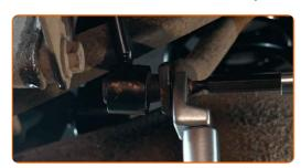
Aperte o fixador que conecta a barra estabilizadora ao braço. Use uma chave combinada nº 16. Use XZN #6. Use uma chave soquete nº 16. Use uma chave de torque. Aperte-o para o torque de 45 Nm.
