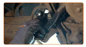
Aperte o fixador da bieleta da barra estabilizadora. Use uma chave combinada nº 16. Use XZN #6. Use uma chave de catraca.
