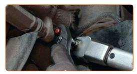
Trate todas as juntas de conexão do estabilizador. Use massa de cobre.
