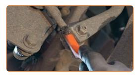
Desaparafuse o fixador que conecta a bieleta da barra estabilizadora à barra estabilizadora. Use uma chave combinada nº 16. Use XZN #6. Use uma chave de catraca.
