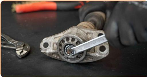
14 Remova o suporte do amortecedor, a coifa e o batente de encosto do amortecedor.
