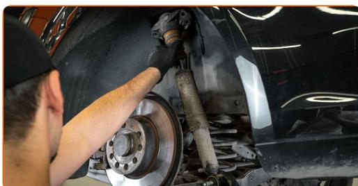
12 Remova a tampa protetora do suporte do amortecedor.
