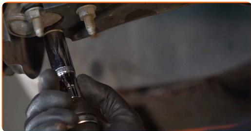
**8** Desaperte o fixador traseiro que liga o braço da suspensão ao subchassi. Use uma chave soquete nº 15. Use uma chave de tarraxa.
