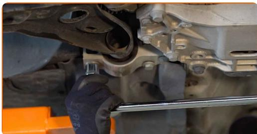
**10** Desaperte o braço de fixação dianteiro. Use uma chave soquete nº 15. Use uma chave soquete nº 18. Use uma chave de tarraxa.
