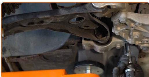
**9** Desaperte o fixador traseiro que liga o braço da suspensão à carroçaria. Use uma chave soquete nº 18. Use uma chave de tarraxa.
