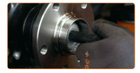
Instale a tampa de proteção do rolamento do cubo. Use um martelo.
