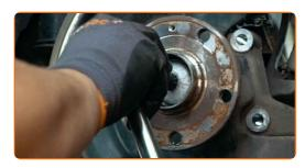
Remova o parafuso de fixação.
