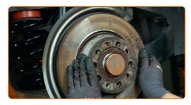
Aperte a fixação do disco de travão. Use Torx T30. Use uma chave de torque. Aperte-o para o torque de 4 Nm.
