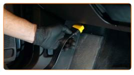
Coloque o sistema de travagem de estacionamento em modo de serviço.
