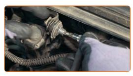
Desaperte a tampa do reservatório de líquido dos travões.
