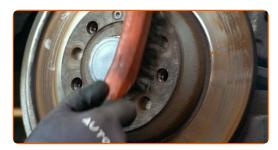
Desaperte a fixação do disco de travão. Use Torx T30. Use uma chave de fenda de impacto.
