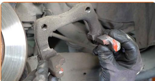
**16** Limpe os elementos de fixação do disco de travão. Use uma escova metálica. Use spray WD-40.
