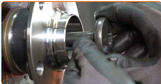
**27** Aperte o cubo. Use XZN #18. Use uma chave de torque. Aperte-o para o torque de 180 Nm.
