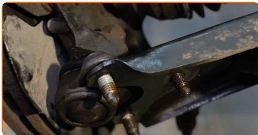
**54** Aperte os parafusos que ligam a junta esférica ao braço de suspensão. Use uma chave soquete nº 16. Use uma chave de catraca.
