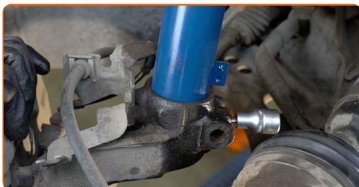
**50** Instale o parafuso de fixação.
