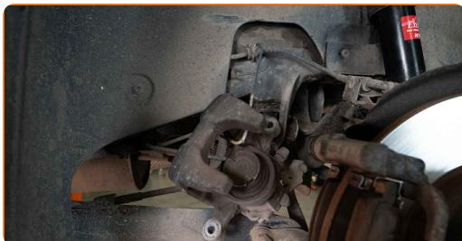
Substituição: pastilhas de travão – VW Jetta IV (162, 163, AV3, AV2).
