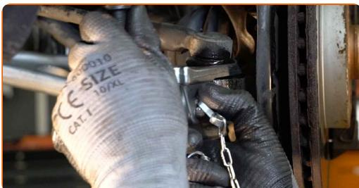
11 Desaparafuse a extremidade da barra de direção.
