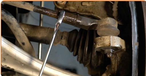
9 Desenrosque a extremidade da porca de fixação da manga de eixo. Use uma chave soquete nº 18. Use uma chave de tarrafa.
