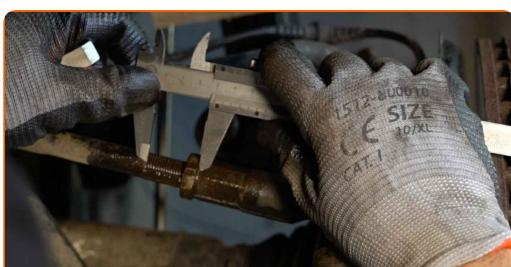
8 Solte a porca de bloqueio que prende o terminal de direção à barra de direção. Use uma chave combinada nº 24.
