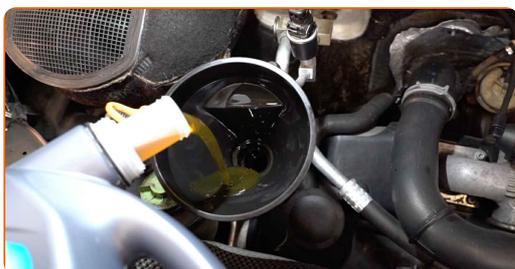
Substituição: óleo do motor e filtro – VW LT 28-35 I Van (281-363). Conselho:
