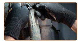
12.1 Limpe os fixadores que conectam as colunas de suspensão às mangas de eixo.
