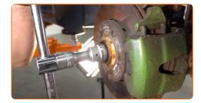
Trate os fixadores do amortecedor. Trate todas as juntas do braço. Use massa de cobre.
