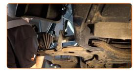
46 Instale o parafuso de fixação.
