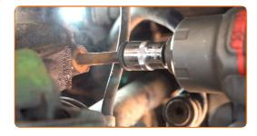
Solte o fixador inferior que conecta a coluna de suspensão às mangas de eixo. Use uma chave especial para remover o amortecedor.
