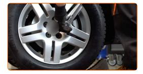
Aperte a fixação superior da montagem do suporte do amortecedor. Use uma chave combinada nº 22. Use HEX n.º H7 Use uma chave de torque. Aperte-o para o torque de 60 Nm.
