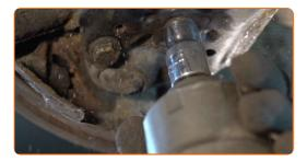
Aperte os fixadores inferiores que conectam a coluna de suspensão à manga de eixo. Use uma chave soquete nº 18. Use uma chave combinada nº 18. Use uma chave de torque. Aperte-o para o torque de 60 Nm.+90°
