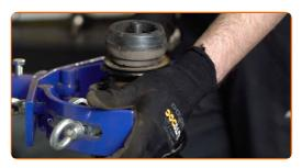
Retire a coluna de suspensão montada.
