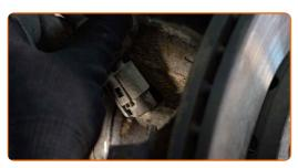
Aparafuse a porca do eixo de transmissão. Use a chave de caixa de 12 pontos n.º 30. Use uma chave de tarraxa.
