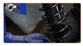
Instale o amortecedor no arco da roda.
