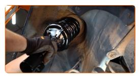
Aparafuse a fixação superior de montagem do suporte do amortecedor. Use uma chave soquete nº 13. Não o aperte.
