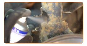
12.2 Limpe todas as juntas do braço. Use uma escova metálica. Use spray WD-40.
