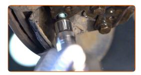
Desaperte o fixador que liga o eixo de transmissão ao cubo de roda. Use a chave de caixa de 12 pontos n.º 30.
