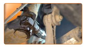
Remova o parafuso de fixação.
