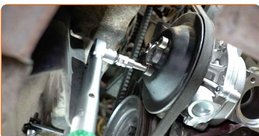
**34** Aparafuse os fixadores da carcaça da bomba de água. Use uma chave soquete nº 10. Use uma chave de catraca.
