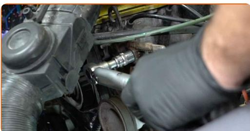
**33** Aperte o fixador da polia da bomba de água. Use HEX n.º H6. Use uma chave de torque. Aperte-o para o torque de 9 Nm.
