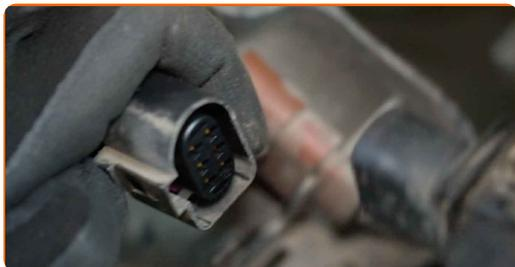
**7** Desaparafuse o fixador do sensor de oxigénio. Utilize um encaixe de sensor de oxigénio de 22 mm. Use uma chave de catraca.
