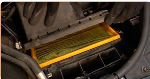
**9** Remova o elemento de filtro a partir da caixa do filtro.
