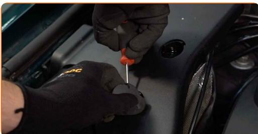
**4** Desaperte os parafusos de fixação da tampa do filtro de ar. Use a chave Phillips.
