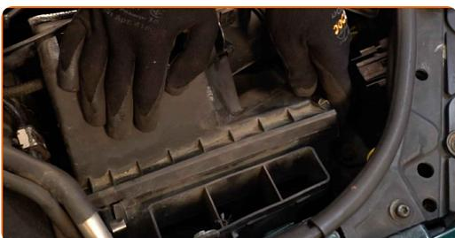
**8** Levante levemente a tampa da caixa do filtro de ar.
