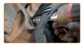
Desenrosque o elemento que fixa o tirante da barra estabilizadora ao braço de suspensão. Use uma chave soquete nº 15. Use uma chave de catraca.
