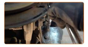
Instale a fixação da haste à barra estabilizadora e aperte-a. Use uma chave combinada nº 14. Use XZN #6. Use uma chave soquete nº 15. Use uma chave de torque. Aperte-o para o torque de 45 Nm.
