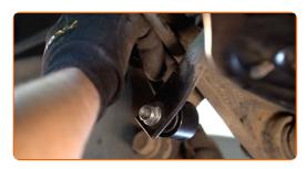
Aperte o fixador que conecta a bieleta da barra estabilizadora à barra estabilizadora. Use uma chave combinada nº 14. Use XZN #6. Use uma chave soquete nº 15. Use uma chave de torque. Aperte-o para o torque de 45 Nm.
