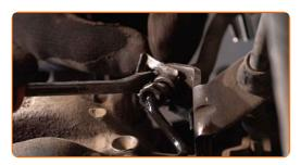
Remova o clipe de retenção do cabo do travão de estacionamento. Utilize um pé-de-cabra.
