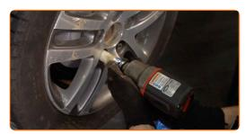
Baixar o carro e trabalhar em ordem transversal, apertar os parafusos das rodas. Use uma chave de torque. Aperte-o para o torque de 120 Nm.
