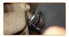
Desaperte o elemento fixador que junta a tubagem do travão à pinça do travão. Use uma chave combinada nº 11.
