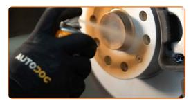
Limpe a superfície do disco de travão. Utilize um produto de limpeza para travões.
