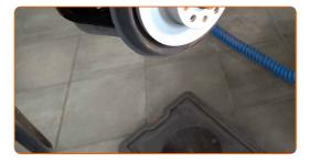
Desaperte o elemento fixador que junta o tubo do travão à mangueira do travão. Use uma chave combinada nº 11.
