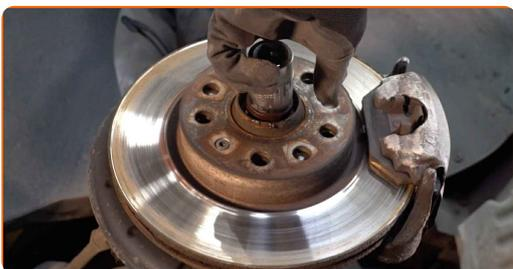
**24** Remova o parafuso de fixação.
