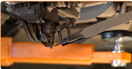
**23** Desaperte o fixador que liga o eixo de transmissão ao cubo de roda. Use uma chave soquete nº 27.
