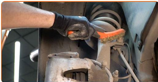
**15** Limpe os fixadores que conectam as colunas de suspensão às mangas de eixo. Use uma escova metálica. Use spray WD-40.
