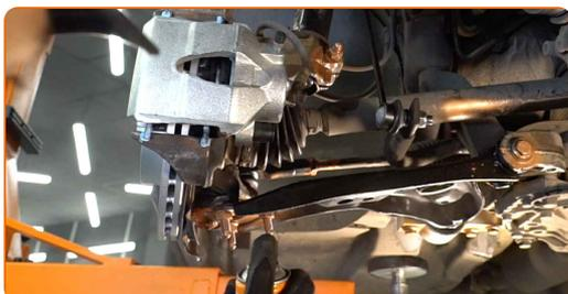
**66** Limpe a superfície do disco de travão. Use uma escova metálica.
