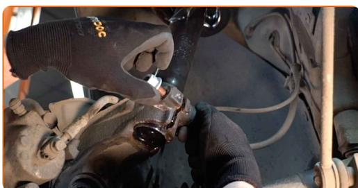
**54** Aperte os fixadores inferiores que conectam a coluna de suspensão à manga de eixo. Use uma chave soquete nº 18. Use XZN #12. Use uma chave de catraca.
