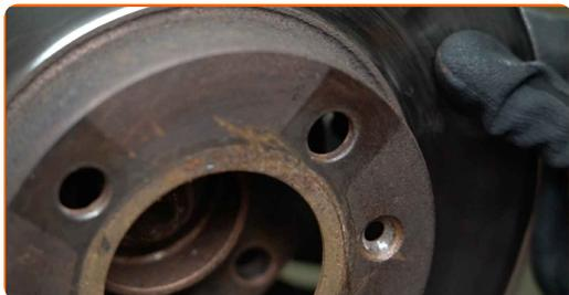
**16** Limpe o cubo. Use uma escova metálica. Trate a superfície de contacto. Use massa de cobre.
