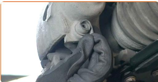
**8** Limpe os elementos de fixação da pinça de travão. Use uma escova metálica. Use spray WD-40.
