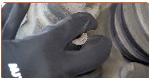
**25** Trate a superfície onde o disco de travão entra em contacto com o aro da roda. Use massa de cobre.
