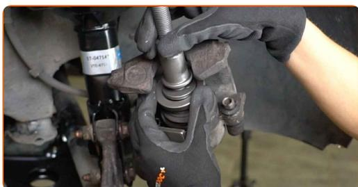
**23** Instale a pinça do travão e fixe-o. Use HEX n.º H7 Use uma chave de torque. Aperte-o para o torque de 25 Nm.
