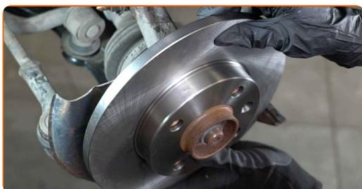
**19** Aperte a fixação do disco de travão. Use Torx T30. Use uma chave de torque. Aperte-o para o torque de 4 Nm.
