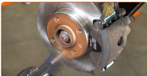
**26** Limpe a superfície do disco de travão. Utilize um produto de limpeza para travões.
