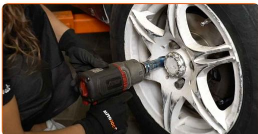
**29** Baixar o carro e trabalhar em ordem transversal, apertar os parafusos das rodas. Use o soquete de impacto para roda #17. Use uma chave de torque. Aperte-o para o torque de 110 Nm.
