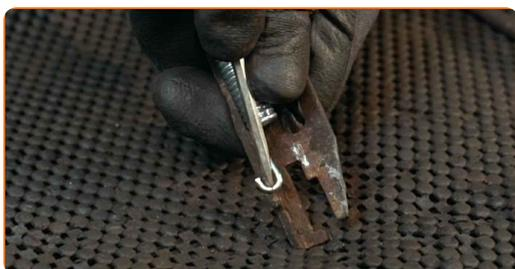
**23** Limpe os assentos de montagem das sapatas de travão. Use o spray de limpeza universal.
