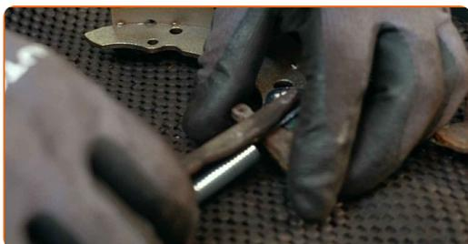
**22** Instale as molas de retenção superiores e o mecanismo de ajuste nos novos calços dos travões. Use uma chave de fenda plana.
