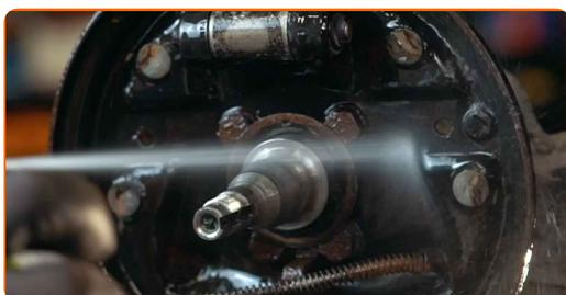
**24** Conecte o cabo do travão de mão à alavanca do travão de estacionamento.
