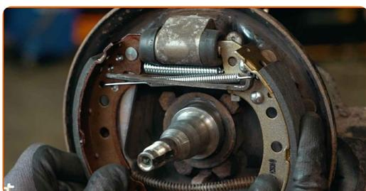
**26** Instale os retentores das sapatas do travão de tambor. Utilize um compressor de molas de retenção das maxilas do travão.
