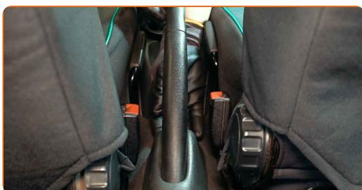
**2** Desaperte o cabo do travão de estacionamento. Use uma chave combinada nº 10.
