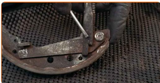
**20** Remova a alavanca de ajuste da sapata de travão.
