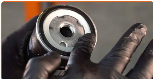
**17** Aparafuse o novo filtro no seu lugar. Use o soquete 76-14F. Use uma chave de torque. Aperte-o para o torque de 18 Nm.
