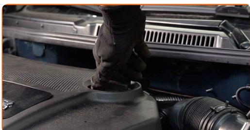
**28** Ligue o motor por alguns minutos. Após a luz de advertência da pressão do óleo se apagar, desligue o motor.
