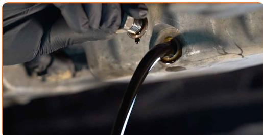
**Substituição: óleo do motor e filtro – VW Passat B1 Variant (33). Conselho da AUTODOC:**
