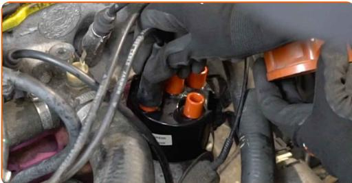
Substituição: rotor do distribuidor – VW Passat B2 Hatchback (32B).
