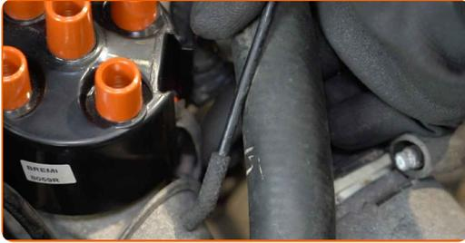
11 Trate dos fios conectores das velas de ignição. Use graxa dielétrica.
