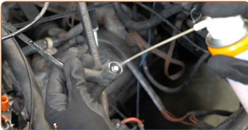
12 Conecte os cabos da vela de ignição à tampa do distribuidor.
