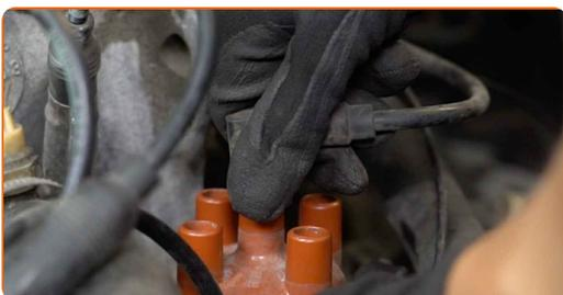
Substituição: rotor do distribuidor – VW Passat B2 Hatchback (32B). Conselho da AUTODOC:
