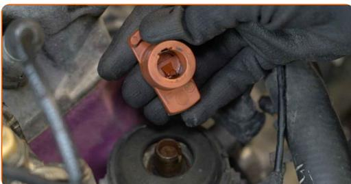
Substituição: rotor do distribuidor – VW Passat B2 Hatchback (32B). Os profissionais recomendam:
