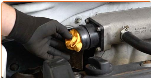
**11** Solte os retentores da carcaça do filtro de ar. Retirar a caixa do filtro de ar.
