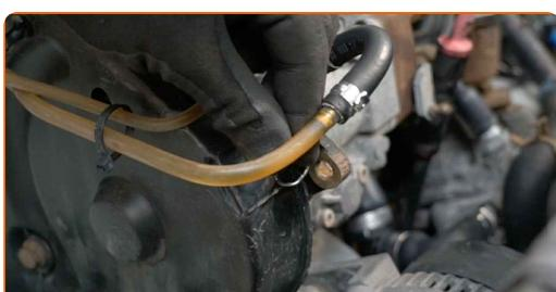
**13** Desaparafuse os fixadores da cobertura superior da correia de distribuição. Use uma chave soquete nº 13. Use uma chave de catraca.
