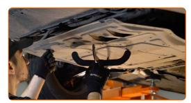
Aperte os fixadores da tampa inferior do cárter. Use uma chave soquete nº 12. Use uma chave de catraca.
