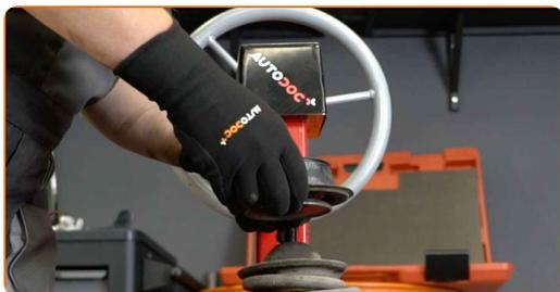
**Substituição: cabeçotes do amortecedores – VW Passat B3/B4 Variant (3A5, 35i). Conselho da AUTODOC:**
