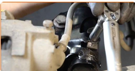
**42** Trate os fixadores do amortecedor. Use massa de cobre.
