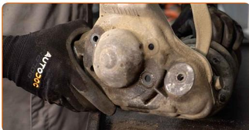
**29** Limpe todas as juntas do braço. Use uma escova metálica. Use spray WD-40.
