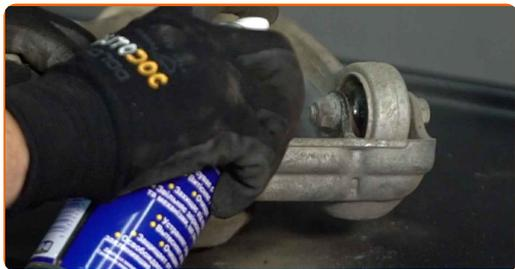
**30** Desaparafuse os fixadores que ligam os braços de suspensão ao suporte do amortecedor. Use uma chave soquete nº 16. Use uma chave combinada nº 16.
