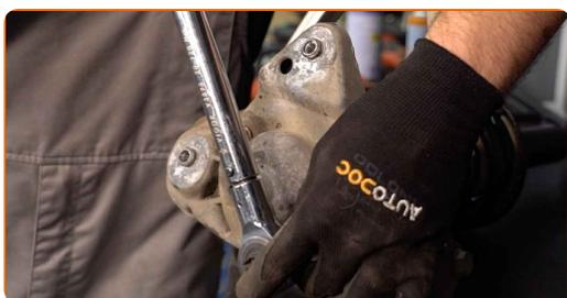
**41** Instale o amortecedor no arco da roda.
