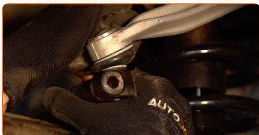
**50** Instale o parafuso de fixação.
