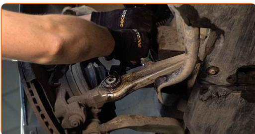
**45** Instale o parafuso de fixação.
