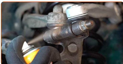
**61** Trate a superfície onde o disco de travão entra em contacto com o aro da roda. Use massa de cobre.
