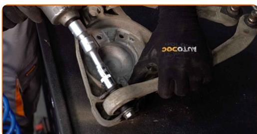
**31** Remova o parafuso de fixação.
