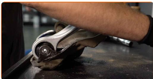
Substituição: braço superior da parte dianteira – VW Passat B5 Sedan (3B2).
