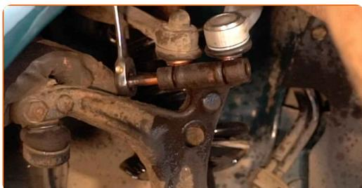
**51** Aparafuse os fixadores (duas peças) do braço de suspensão superior. Use uma chave combinada nº 16. Use uma chave soquete nº 16.
