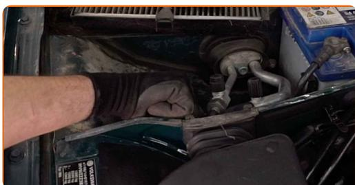
**43** Limpe os assentos de montagem da coluna do amortecedor. Use uma escova metálica. Use spray WD-40.
