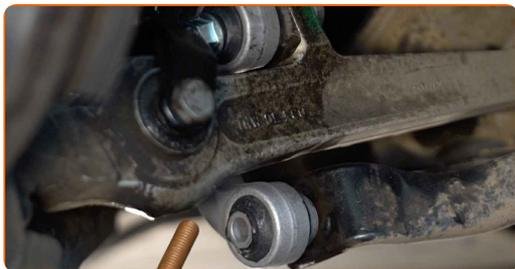
**58** Aperte o fixador que conecta a barra estabilizadora ao braço. Use uma chave combinada nº 16. Use uma chave soquete nº 16. Use uma chave de torque. Aperte-o para o torque de 40 Nm.+90°
