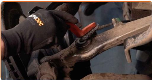
**44** Conecte o braço da suspensão à coluna de suspensão.
